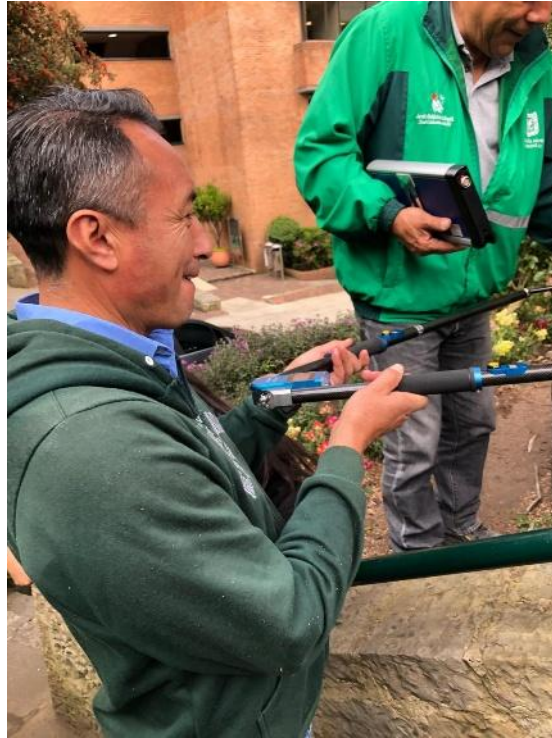
Figura 2. Medición de la geometría del árbol con la forcípula del tomógrafo.
