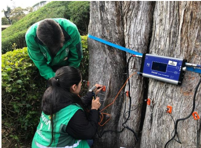
Figura 3. Captura de señales sónicas mediante el equipo PiCUS 3
